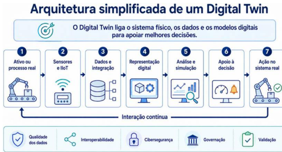
Figura 16: Arquitetura simplificada de um Digital Twin.
